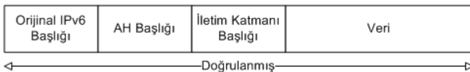
Şekil 16: Transport kipinde AH kullanımı paket yapısı
